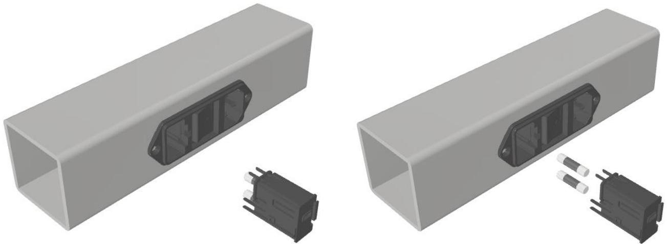
4. Prüfen der Sicherung: Sicherungshalter mit den beiden Sicherungen vor einen hellen Hintergrund halten. Nun sind die Schmelzdrähte der Sicherungen zu sehen. Sind sie intakt, oder ist einer von beiden getrennt und damit die Sicherung defekt? Ist einer von beiden defekt, so sollten beide Sicherungen getauscht werden.
